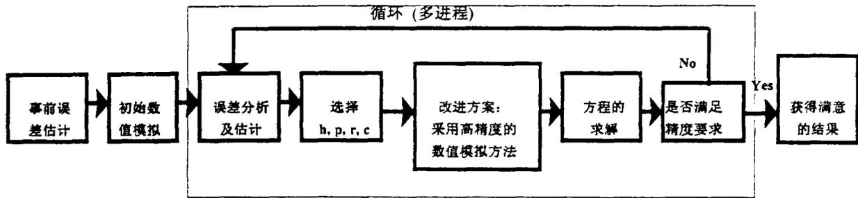
图1 高精度数值分析及自适应方法的实施过程
